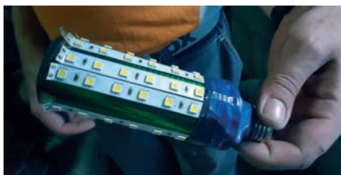
Фото 5 и 6. Светодиодная лампа мощностью 14,2 Вт. сконструирована из алюминиевой банки, цоколя от использованной лампы накаливания, светодиодной ленты и изолянта, на 220 вольт. Лампа установлена в подвале дома № 38.
